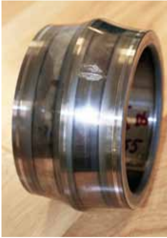
En av de skadade innerringar som man upptäckte vid mätningar på bandpressar i Hallstavik.
